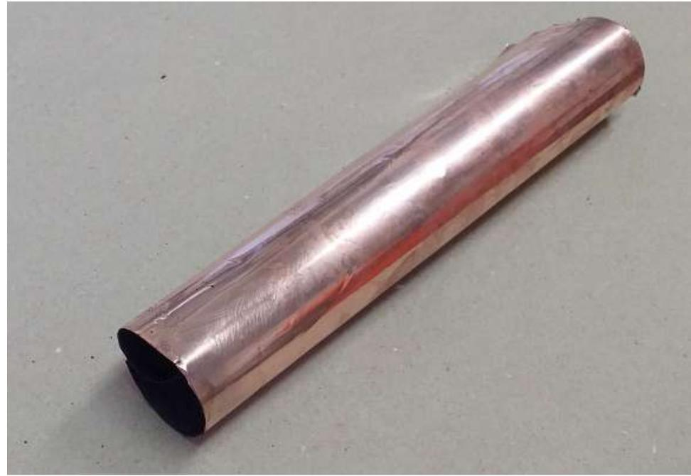
**Cátodo de cobre cilíndrico**
