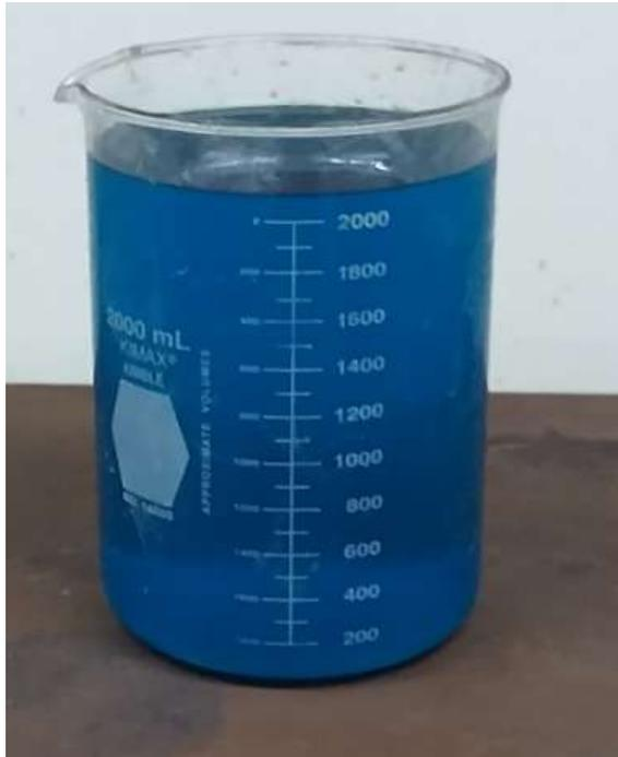
**Sulfato de cobre como reactivo de flotación**
